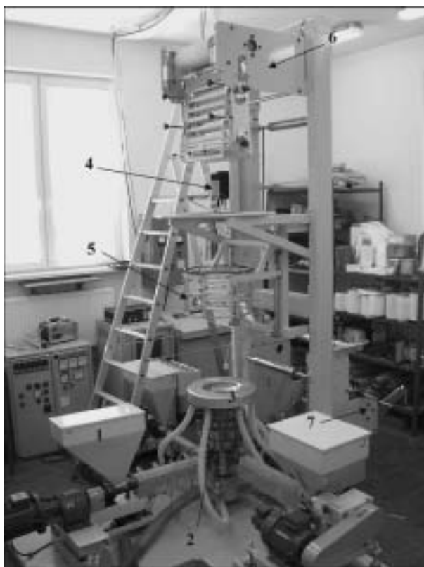
Rys. 1. Linia technologiczna wytłaczania z rozdmuchiwanym folii: 1 — wytłaczarka, 2 — głowica, 3 — pierścień chłodzący, 4 — układ pomiaru grubości folii, 5 — kosz stabilizujący, 6 — urządzenie odbierające folię, 7 — urządzenie nawijające Fig. 1. Technological line of blowing extrusion of the film: 1 — extruder, 2 — head, 3 — cooling ring, 4 — measuring system of film thickness, 5 — stabilizing basket, 6 — film collecting system, 7 — wind-up reel
