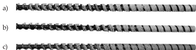
Rys. 6. Wpływ prędkości obrotowej ślimaka na wypełnienie ślimaka w procesie wytłaczania z dozowanym zasilaniem kompozytu WF/PP_25/75, na poziomie odpowiadającym 90 % wydajności wytłaczania bez dozowania: a) N = 20 obr/min, G = 6,25 kg/h, G/N = 0,313 , b) N = 50 obr/min, G = 12,86 kg/h, G/N = 0,257 , c) N = 80 obr/min, G = 19,23 kg/h, G/N = 0,240
