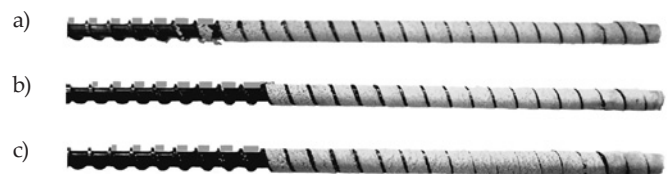
Rys. 4. Wpływ prędkości obrotowej ślimaka na wypełnienie ślimaka w procesie wytłaczania z dozowanym zasilaniem tworzywa WF/PP_75/25, na poziomie odpowiadającym 90 % wydajności wytłaczania bez dozowania: a) N = 20 obr/min, G = 7,21 kg/h, G/N = 0,361 , b) N = 50 obr/min, G = 13,81 kg/h, G/N = 0,276 , c) N = 80 obr/min, G = 19,85 kg/h, G/N = 0,248
