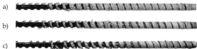
Rys. 5. Wpływ prędkości obrotowej ślimaka na wypełnienie ślimaka w procesie wytłaczania z dozowanym zasilaniem kompozytu WF/PP_50/50, na poziomie odpowiadającym 90 % wydajności wytłaczania bez dozowania: a) N = 20 obr/min, G = 6,61 kg/h, G/N = 0,331 , b) N = 50 obr/min, G = 13,56 kg/h, G/N = 0,271 , c) N = 80 obr/min, G = 19,55 kg/h, G/N = 0,244
