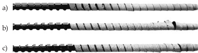
Rys. 1. Wpływ dozowanego zasilania na wypełnienie ślimaka w procesie wytłaczania tworzywa WF/PP_75/25, z prędkością obrotową ślimaka N = 80 obr/min: a) G = 22,41 kg/h, G/N = 0,280 , b) G = 20,38 kg/h, G/N = 0,254 , c) G = 19,85 kg/h, G/N = 0,246
