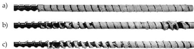
Rys. 2. Wpływ dozowanego zasilania na wypełnienie ślimaka w procesie wytłaczania kompozytu WF/PP_50/50, z prędkością obrotową ślimaka N = 80 obr/min: a) G = 22,15 kg/h, G/N = 0,277 , b) G = 20,67 kg/h, G/N = 0,258 , c) G = 19,55 kg/h, G/N = 0,244
