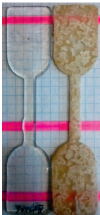
Rys. 1. Wygląd próbek PUR syntezowanych z TMDI, PCL 750 i GLI, przed (lewa) i po (prawa) biodegradacji
