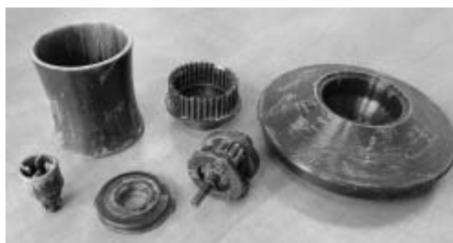
Rys. 4. Widok elementów przekładni robota kuchennego wykonanych z kompozytu RenPIM-VG 5286/3 % mas. Nanobent® ZR1
