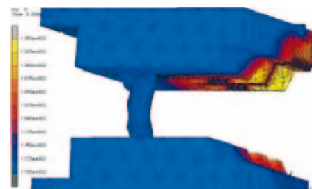
Rys. 7. Deformacja węzła słup-tuleja prowadząca Fig. 7. Deformation of the leader pin-guide bushing
