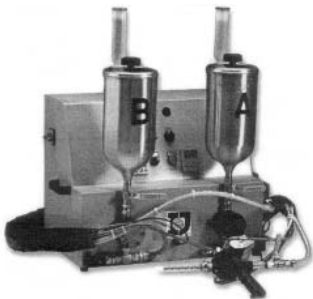
Rys. 5. Agregat dozująco-mieszający RIM Fig. 5. RIM feeding-mixing set
