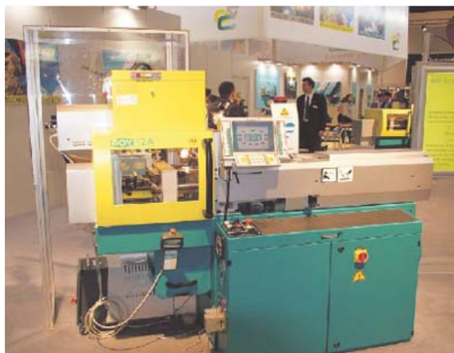
Rys. 3. Wtryskarka firmy Boy do wytwarzania mikrowyprasek wyposażona w komorę czystego powietrza [18]
