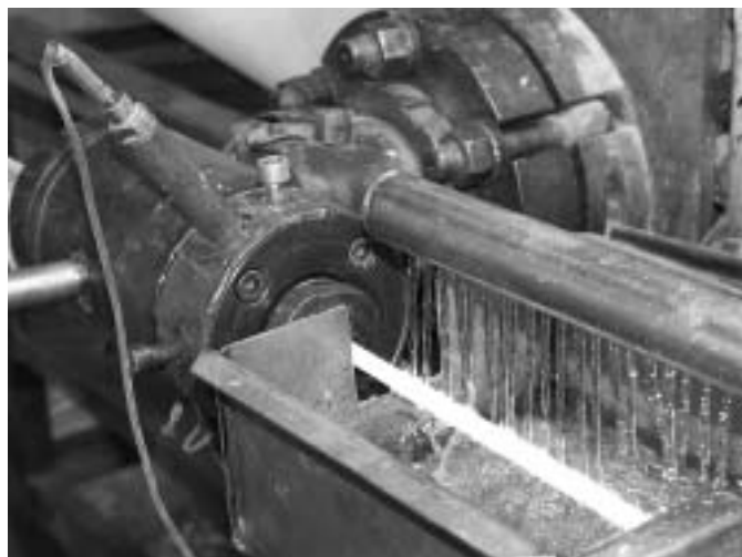
Rys. 2. Wygląd głowicy wyltaczarskiej oraz fragmentu urządzenia ochładzającego wraz z wytwarzanym kablem
