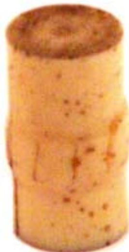
Rys. 5. Charakter zniszczenia zmęczeniowego próbki wykonanej z Epidianu 57 utwardzanego w czasie 1 h w temp. 60 °C, obciążanej cyklem 0,2–5 kN (o wartości maksymalnej równej 0,5 wytrzymałości na ściskanie)
