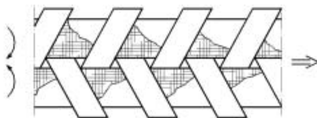
Rys. 3. Schemat przebiegu uplastyczniania tworzywa w dwuślimakowej wytłaczarce przeciwbieżnej
