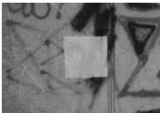
Rys. 2. Efekt usuwania graffiti z zanieczyszczonej ściany Fig. 2. Result of graffiti removal from the wall
