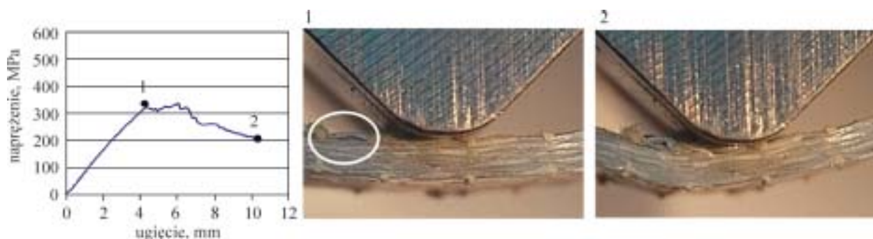
Rys. 5. Krzywa zginania oraz fotografie laminatu zszywanego, kierunek zginania prostopadły do ułożenia szwów: 1 — w chwili inicjacji zniszczenia, 2 — w zaawansowanym stadium zniszczenia; widoczne niewielkie pęknięcia delaminacyjne w górnej części próbki (1) i jego rozwój (2) Fig. 5. Bending curve and the photos of stitched laminate; bending direction perpendicular to stitches; 1 — at the moment of failure initiation, 2 — at advanced failure stage. Small delamination crack visible at upper part of specimen (1) and its development (2)
