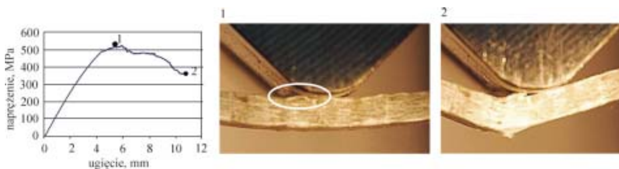
Rys. 4. Krzywa zginania oraz fotografie laminatu zszywanego, kierunek zginania równoległy do ułożenia szwów: 1 — w chwili zainicjowania zniszczenia, 2 — w zaawansowanym stadium zniszczenia; widoczne niewielkie pęknięcia delaminacyjne w górnej części próbki (1) oraz zerwanie warstw wzmacniających w dolnej części (2) Fig. 4. Bending curve and the photos of stitched laminate; bending direction parallel to the stitches; 1 — at the moment of failure initiation, 2 — at advanced failure stage. Small delamination crack visible at upper part of specimen (1) and a break of reinforcing layers at lower part (2)
