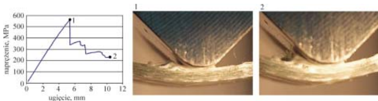
Rys. 3. Krzywa zginania oraz fotografie laminatu niezszywanego: 1 — w chwili zainicjowania zniszczenia, 2 — w zaawansowanym stadium zniszczenia; widoczne obszerne pęknięcia delaminacyjne w górnej części próbki (1) oraz jego rozrost (2) Fig. 3. Bending curve and the photos of non-stitched laminate: 1 — at the moment of failure initiation, 2 — at advanced failure stage. Vast delamination crack visible at upper part of specimen (1) and its development (2)
