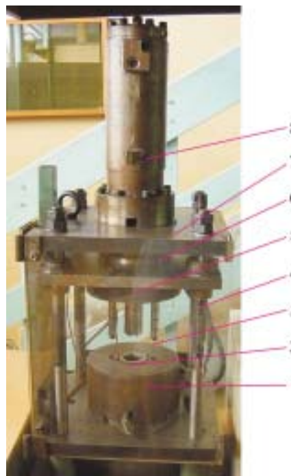
Rys. 1. Wygląd ogólny standardowego plastometru BIP: 1 — płyta dolna, 2 — czujnik temperatury, 3 — matryca, 4 — słupy prowadzące, 5 — stempel, 6 — płyta ruchoma, 7 — płyta górna, 8 — siłownik hydrauliczny
