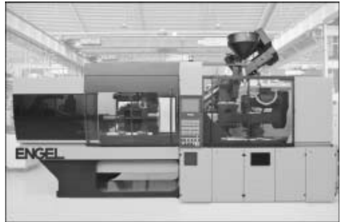
Rys. 8. Wtryskarka „E-Motion E55” firmy Engel z bezcolumnowym układem narzędziowym [13] Fig. 8. „E-Motion E55 injection molding machine, by Engel, with tie-bar-less clamping unit [13]
