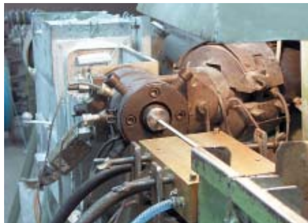
Rys. 7. Fragment linii technologicznej wytwarzania porowanej powłoki kabla
