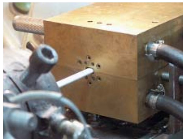
Rys. 8. Wygląd kalibratora próżniowo-ciśnieniowego podczas działania w linii technologicznej wytwarzania porowanej powłoki kabla
