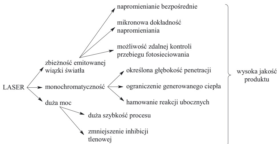
Schemat C. Zalety stosowania lasera do fotopolimeryzacji Scheme C. Advantages of laser use in photopolymerization
