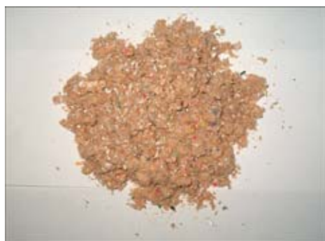
Rys. 5. Produkt otrzymany bezpośrednio z urządzenia do rozwłókniania odpadów wielowarstwowych kartonów
