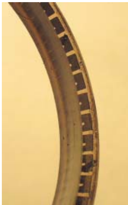
Rys. 4. Uszczelka „Mupuseal 30412” po 90 000 m drogi tarcia. Brak charakterystycznych oznak uszkodzenia. Śladowe ilości cząstek grafitu lub koksu pochodzą z elementów prowadzących wykonanych z PTFE+koks/grafit
