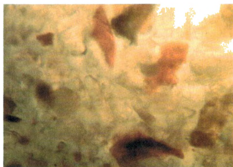
Rys. 2. Obraz ziaren bentonitu — mikroskop optyczny (powiększenie 250×) Fig. 2. Image of bentonite grains in optical microscope (magnification 250 times)
