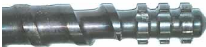
Rys. 2. Fragment ślimaka z elementami intensywnego ścinania i mieszania zastosowanego do badań
