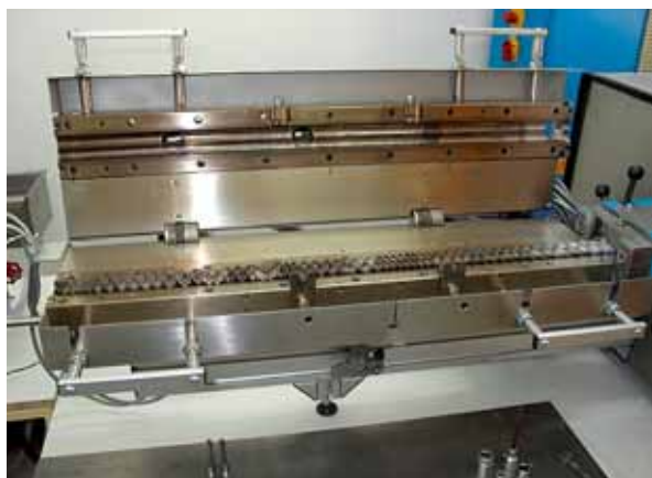
Rys. 1. Układ uplastyczniający wytłaczarki typu „BTSK 20/40D”, firmy Bühler z odwróconą górną częścią cylindra (w dolnej części cylindra widoczne ślimaki)
