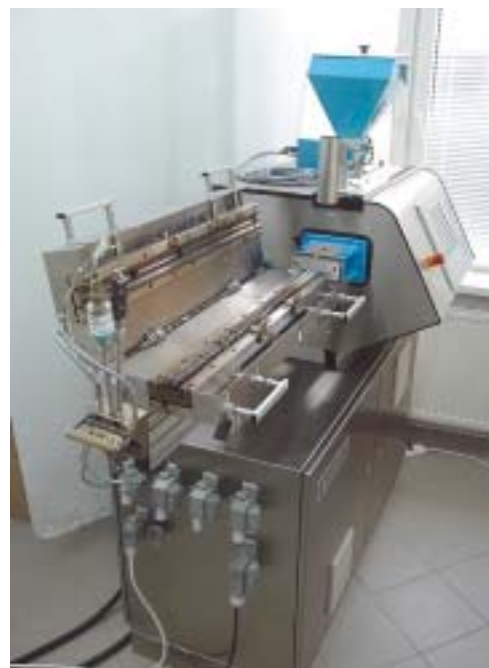
Fot. 2. Laboratoryjna wylączarka dwuślimakowa współbieżna (prod. Buhler)
