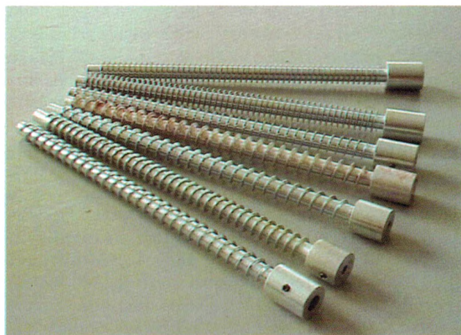
Rys. 4. Zbiór ślimaków toczonych o różnej średnicy i skoku Fig. 4. Set of turned screws of various diameters and pitches
