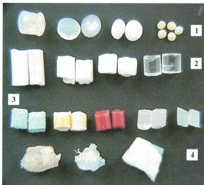
Rys. 1. Wpływ sposobu otrzymywania tworzyw polimerowych na ich postać: 1 — metoda granulowania na gorąco, 2 i 3 — metoda granulowania na zimno, 4 — aglomeraty folii PE Fig. 1. Effects of plastics' production ways on their forms: 1 — plastics obtained by hot granulation, 2 and 3 — plastics obtained by cold granulation, 4 — PE film agglomerates
