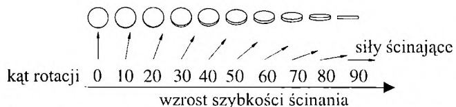
Rys. 8. Schematyczne przedstawienie orientacji cząstek talku w zależności od wartości sił ścinających [wg 29]
