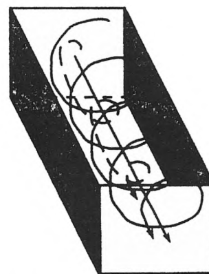
Rys. 5. Schemat przepływu tworzywa w ślimakowym układzie uplastyczniającym wg [17]
