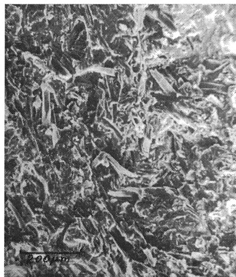
Rys. 7. Kompozycja G6a (45 cz. mas. włókna celulozowego z makulatury z aminosilanem, wylączarka dwuślismakowa) Fig. 7. Composition G6a (with 45 weight parts of scrap paper cellulose fibres, and aminosilane; double-screw extruder)
