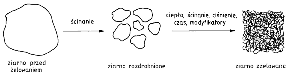
Rys. 5. Uproszczony proces zmiany struktury ziarna PVC w procesie żelowania Fig. 5. Simplified process of PVC morphology change during gelation process
