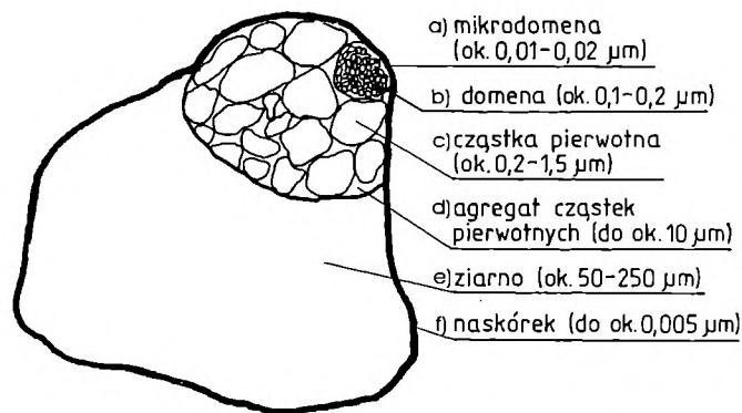
Rys. 4. Schematyczna budowa ziarna PVC-S (bez zachowania proporcji)
