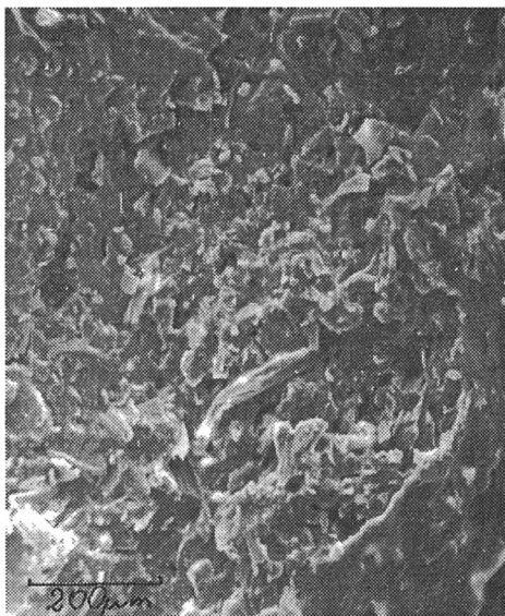
Rys. 5. Struktura kompozycji na podstawie PP "Malen P J 330" zawierającej 42% mas. włókna celulozowego z makulatury (próbka 3 wg tabeli 1)
