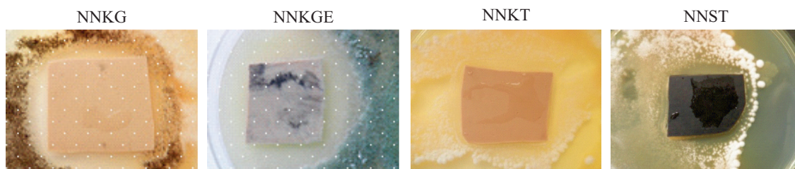
Rys. 4. Strefa zahamowania wzrostu grzybów pleśniowych wokół wulkanizatów kauczuku naturalnego zawierających olejki eteryczne Fig. 4. Zone of inhibition of mould fungi growth around NR vulcanizates containing essential oils
