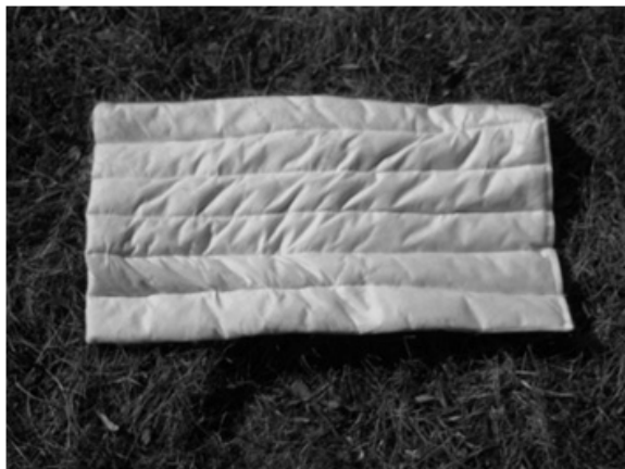
Rys. 8. Mata włóknista do usuwania substancji ropopochodnych Fig. 8. Feather-containing fibrous mat for removal of petroleum spills
