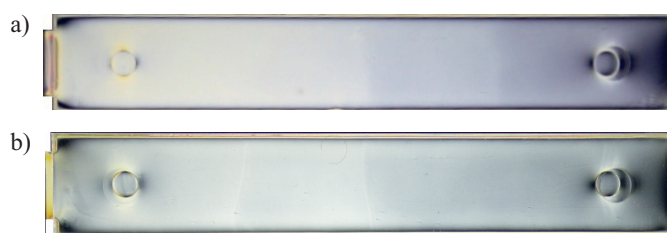
Rys. 10. Obraz stanu naprężeń w wypraskach uzyskanych z zastosowaniem t_w = 2,5 s, t_d = 20 s oraz: a) t_{ou} = 3 s, b) t_{ou} = 60 s (wypraska 9 w tabeli 3)
