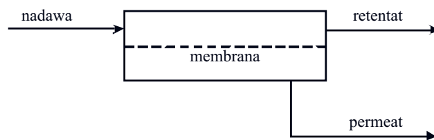
Rys. 1. Zasada procesu filtracji membranowej Fig. 1. Principle of the membrane filtration process
