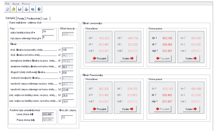
Rys. 5. Dane geometryczne wraz z warunkami technologicznymi względnego ustawienia ślimaków i frezu podczas obróbki, obliczone za pomocą opracowanego programu komputerowego, wspomagającego projektowanie układów dwuślimakowych Fig. 5. Geometric data and technological conditions of the relative setting of worms and mill during machining, calculated by the developed software programme supporting the design of double worm systems
