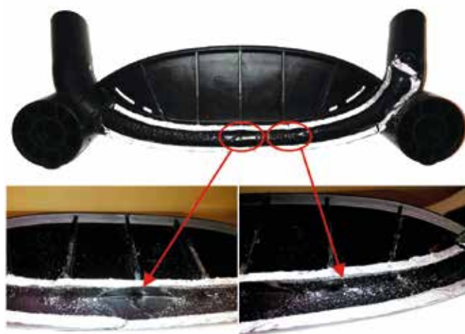
Rys. 6. Wnętrze kanału gazowego wypraski. Penetracja gazu poza kanał gazowy
