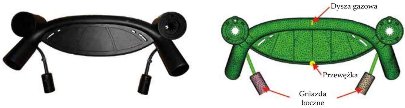
Rys. 3. Fotografia rzeczywistej wypraski oraz model MES przygotowany do symulacji Fig. 3. Photography of a real part and FEM model prepared for simulation
